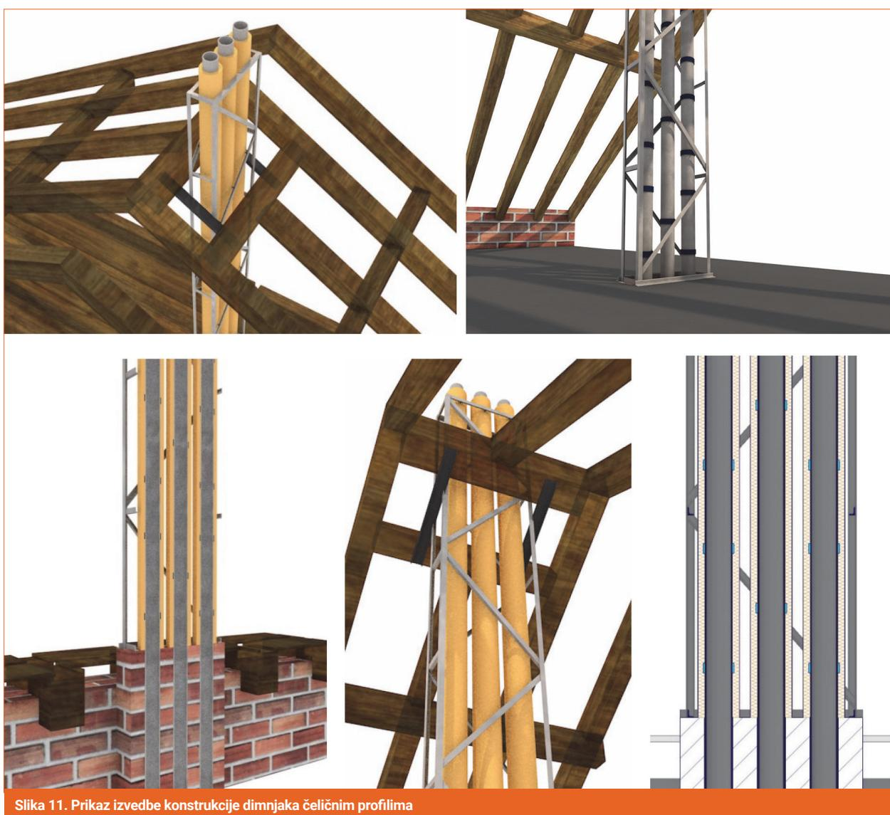
Slika 11. Prikaz izvedbe konstrukcije dimnjaka čeličnim profilima
