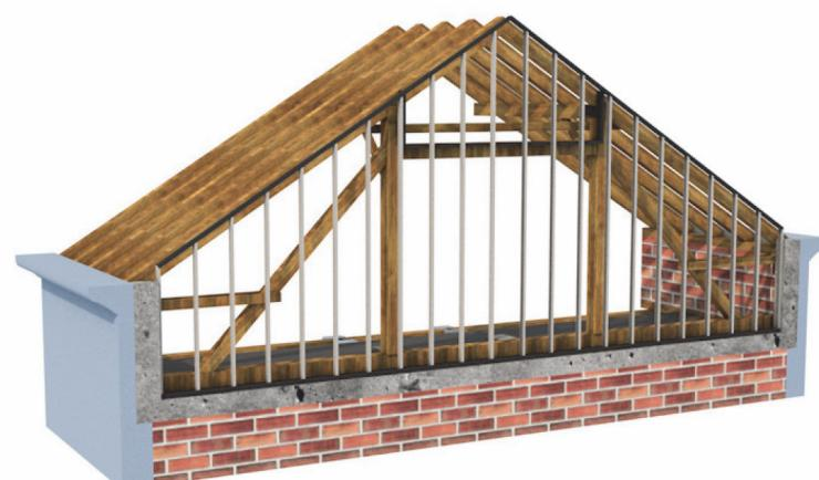
Slika 37. Izvedba zabata konstrukcijom od tankostijenih čeličnih profila
