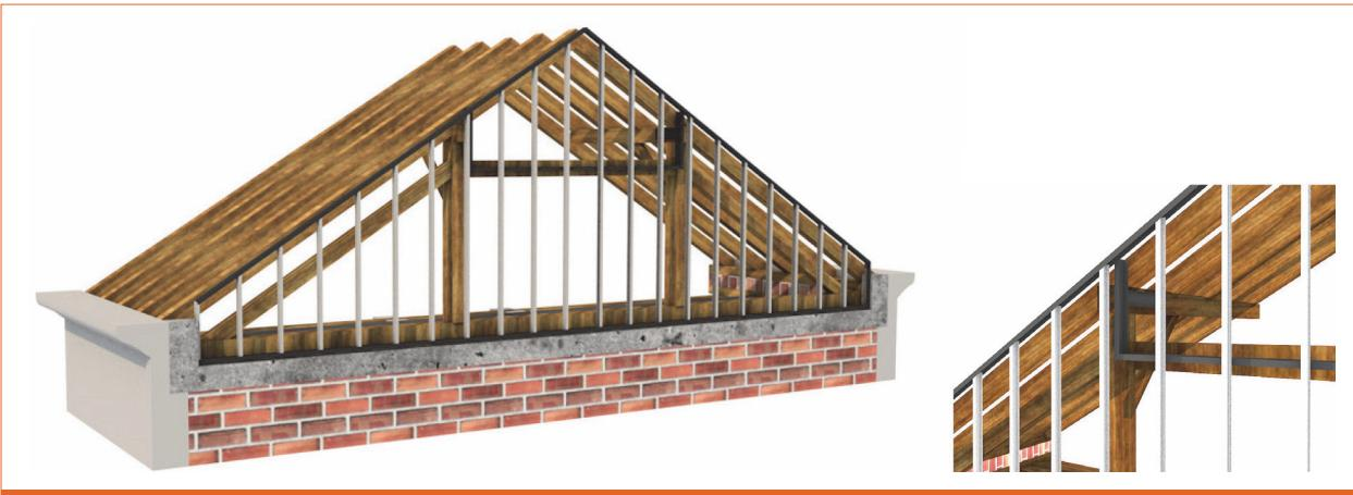
Slika 36. Izvedba zabata konstrukcijom od standardnih čeličnih profila
