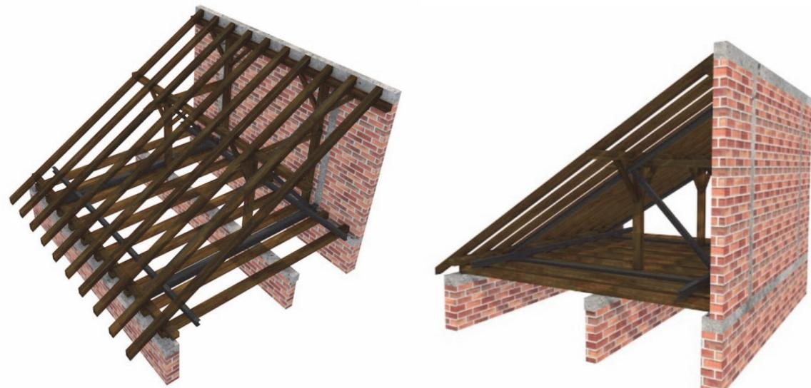
Slika 35. Stabilizacija tavanskih zidova čeličnim profilima
