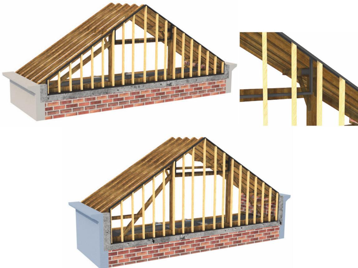
Slika 38. Izvedba tavanskih zabata drvenom vertikalnom konstrukcijom
