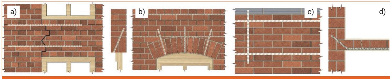
Slika 55. Primjena spiralne armature u sljubnicama: a) zatvaranje pukotina, b) povećanje nosivosti nadvoja, c) osiguranje parapetnih zidova, d) povezivanje unutarnjih i vanjskih zidova
