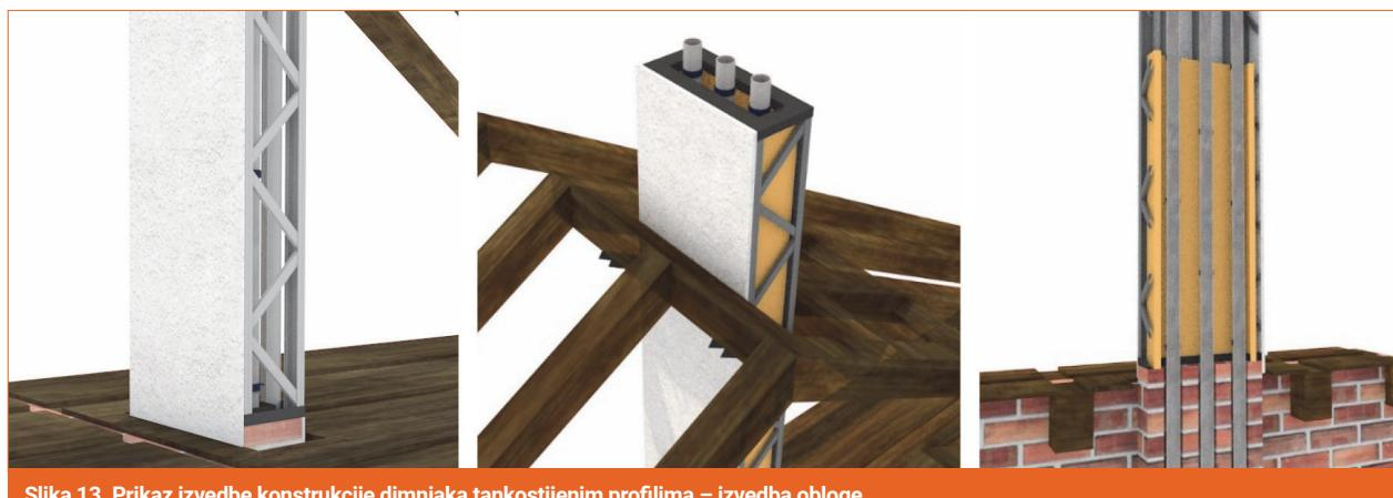
Slika 13. Prikaz izvedbe konstrukcije dimnjaka tankostijenim profilima – izvedba oblage
