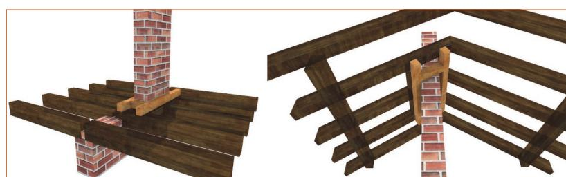
Slika 15. Prikaz lokalnog pridržanja dimnjaka na podnu i krovnu konstrukciju drvenom građom
