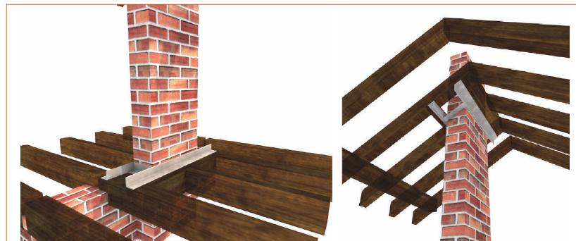
Slika 14. Prikaz lokalnoga pridržanja dimnjaka na podnu i krovnu konstrukciju čeličnim profilima
