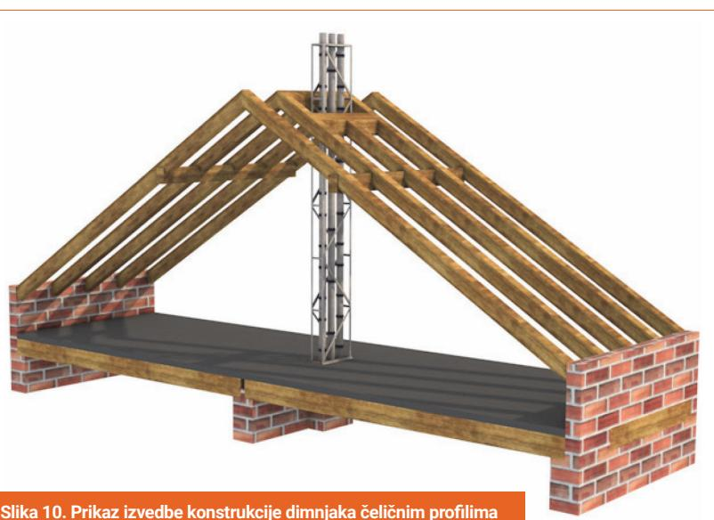
Slika 10. Prikaz izvedbe konstrukcije dimnjaka čeličnim profilima
