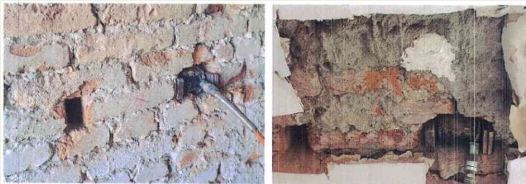
Slika 6.5 - Ispitivanje posmične čvrstoće morta na mjestima 3-2 i 3-3 na 3. katu zgrade
