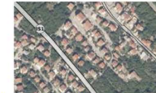
planirana cesta područnog (regionalnog) značaja odabrani elementi: kategorija ceste 5-4 (Vp=60 km/h); širina profila = 8,4 m + 2 x 100 cm biciklistička staza = 2,0 m + 2 x 100 cm zemljišni pojas = 2,0 m UKUPNO 12,4 m
