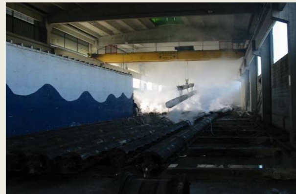
Prikaz zaparivanja pilota
