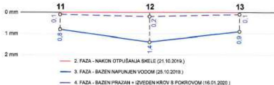
Slika 3.3 - Rezultati mjerenja vertikalnih pomaka na mjernim mjestima 11, 12 i 13
