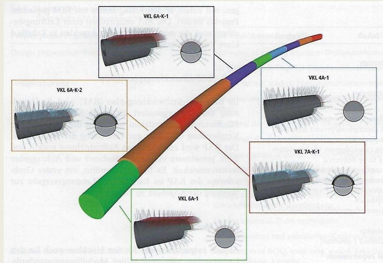
Primjer detaljnih modela za klase iskopa označene duž cijelog tunela.
