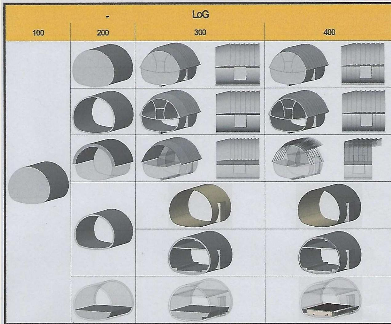
Pregled klasifikacije\*) razine razvoja geometrije kod konvencionalnog tipa tunelogradnje prema smjernicama za primjenu BIM tehnologije, tzv. LOG razine
