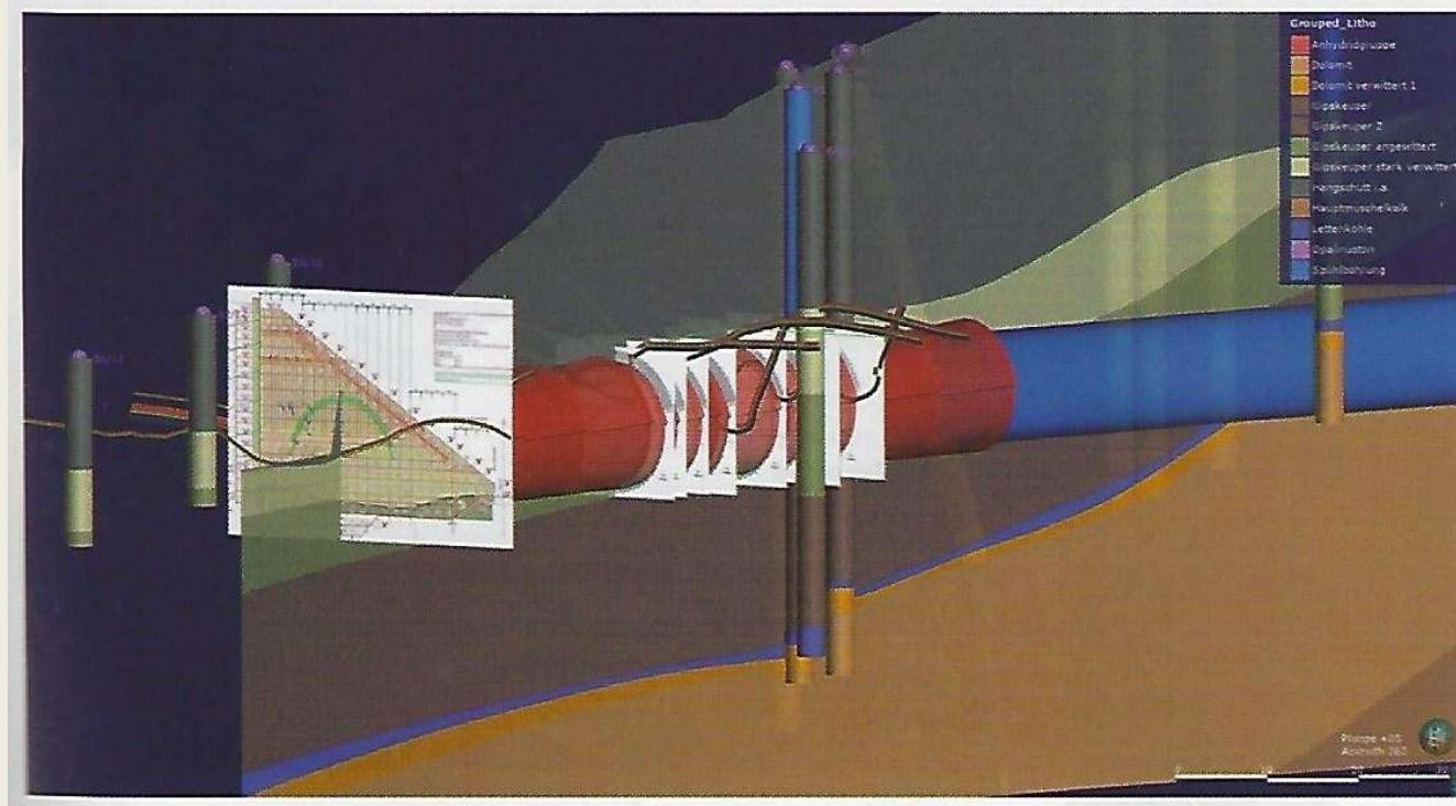
3D modeliranje tla s razvojnom dopunom informacija o nađenim dodatnim informacijama na primjeru 2 cijevi željezničkog tunela Bözberg.
