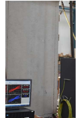
Point C Displacement -37.9 [mm] IDR = 1.4
