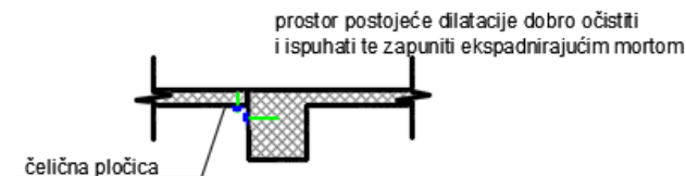
spoj dilatacija preko postojeće grede i postojeće ploče
