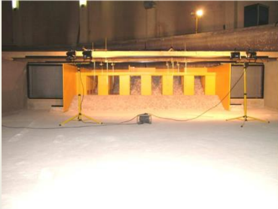
Fizikalni model u ispitnom položaju za JZ smjer nailaska valova (A-set mjerenja)
