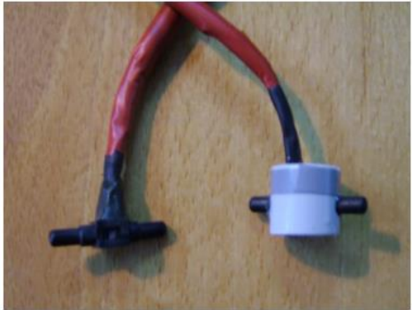
Tlakomjeri (lijevo – ožičen, desno – ožičen i vodonepropusno zaštićen)
