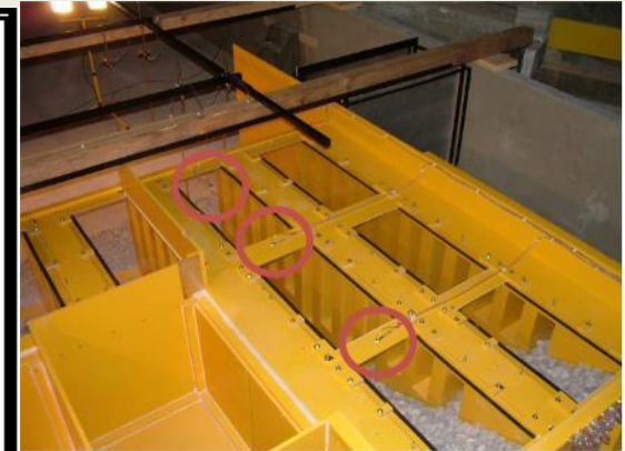
Tlakomjer instaliran na krovu modelskog segmenta dugih kolona (P25 – P27)
