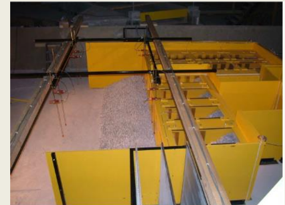
Kapacitivne valne sonde na mjernim pozicijama G1 do G8 ispred fizikalnog modela
