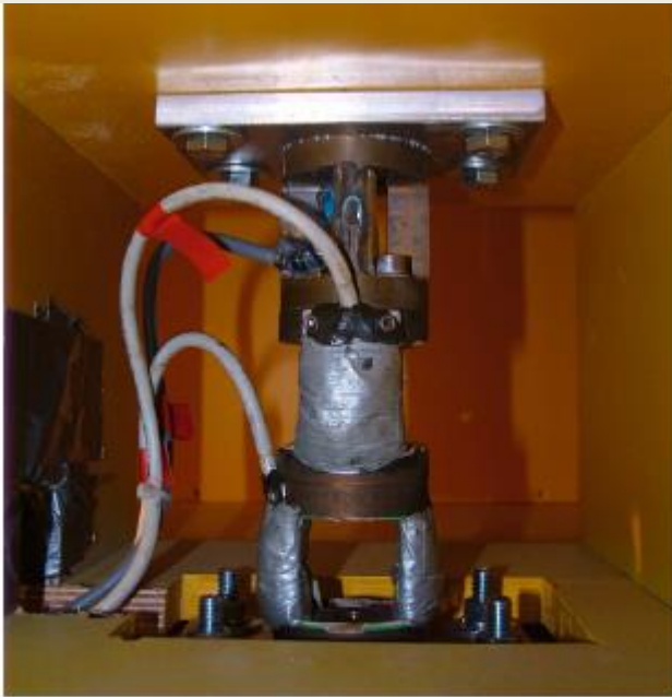
Dinamometri sila instalirani u kesonu modelskog segmenta kratkih kolona (D1, D2 and D3)
