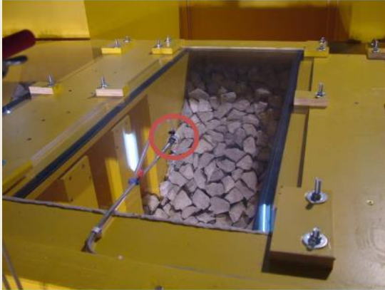
Tlakomjer instaliran na krovu modelskog segmenta kratkih kolona (P24)
