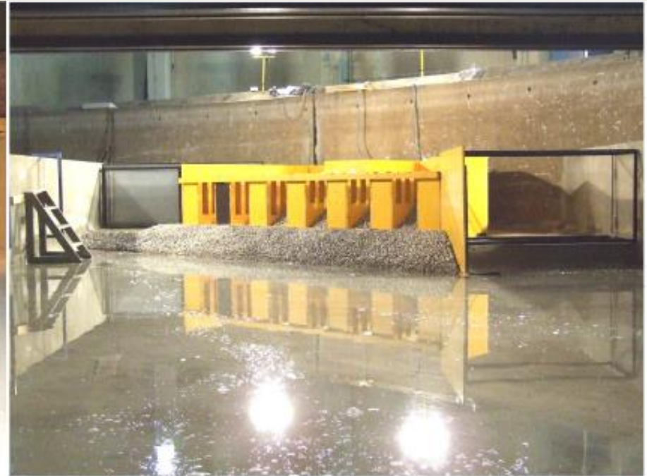
Fizikalni model u ispitnom položaju za JJI smjer nailaska valova (B-set mjerenja)
