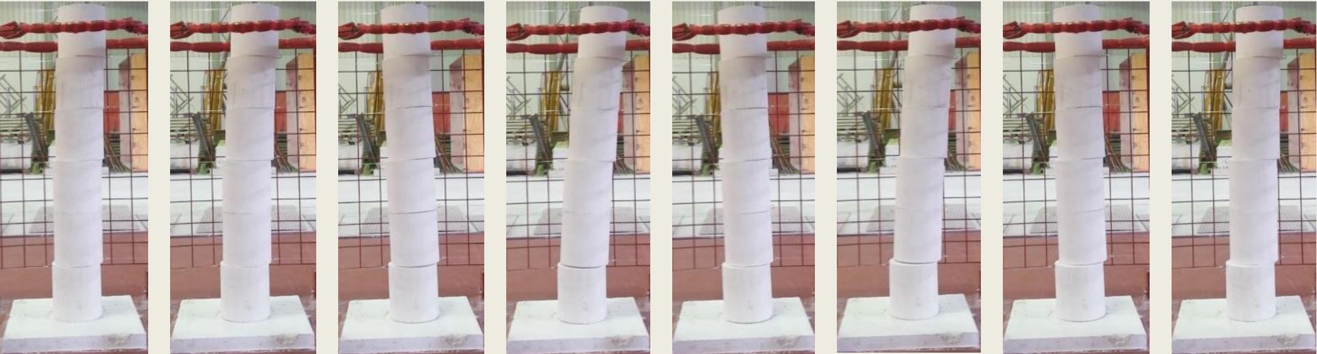
Pomaci stupa C-DJ (suha sljubnica) za akcelerogram Petrovac pri a_{gmax} = 1.6 \text{ ms}^{-2}
