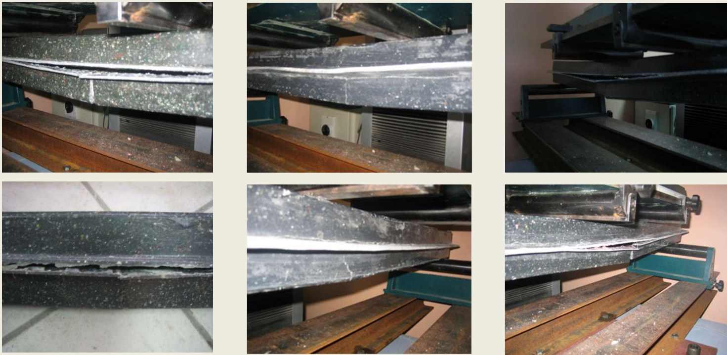
Slika 10. Načini popuštanja elemenata RŠ1, RŠ2 i RŠ3
