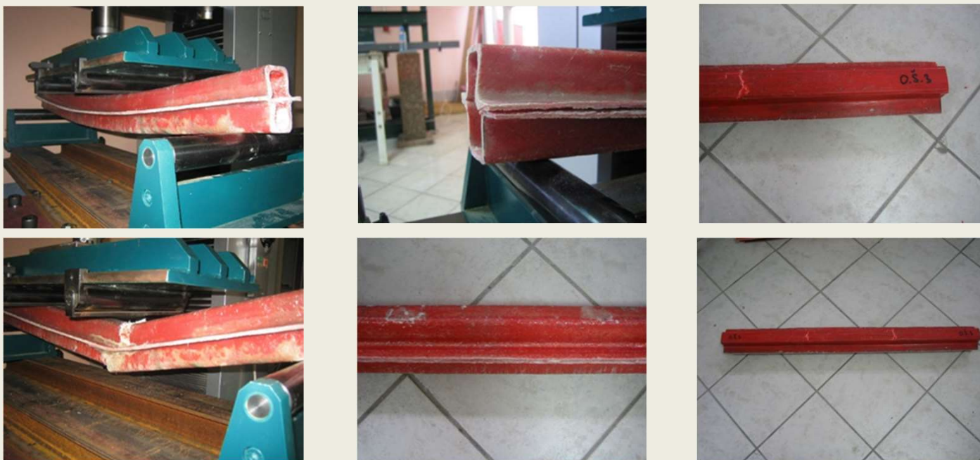
Slika 8. Načini popuštanja elemenata OŠ1, OŠ2 i OŠ3
