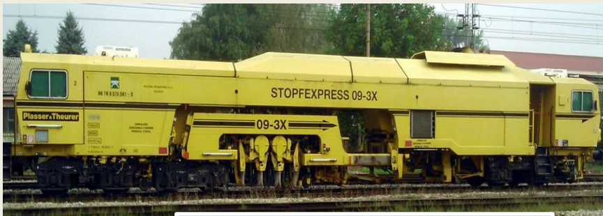
Stroj za reguliranje kolosijeka sa mogućnošću mjerenja geometrije
